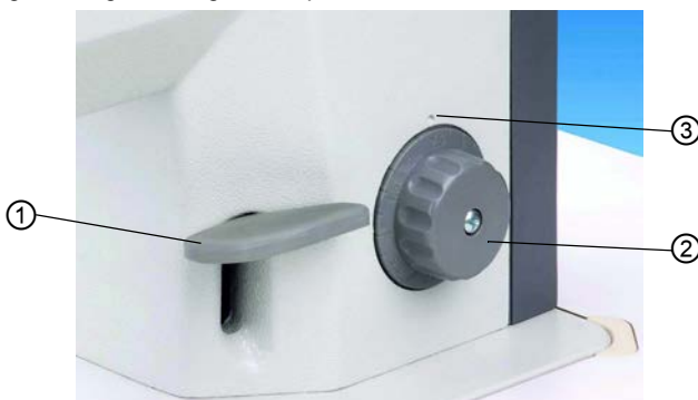
Fig. 18: Régler la longueur de point
